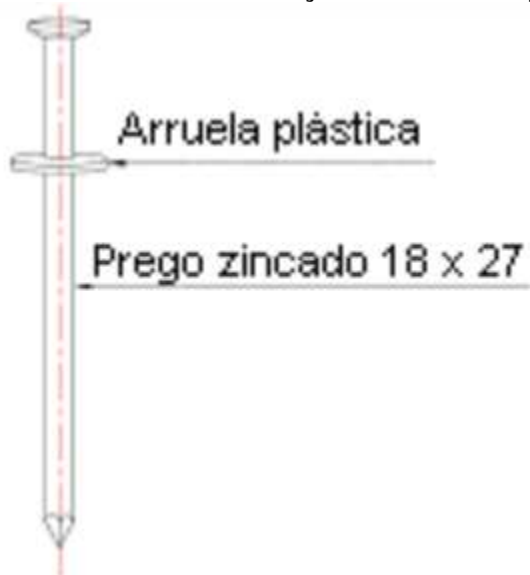
Imagem 7 – Prego zincado utilizado na fixação de telhados tipo pequenas ondas
