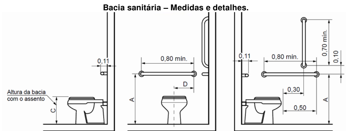
Vista Superior e medidas das barras de apoio das bacias.
