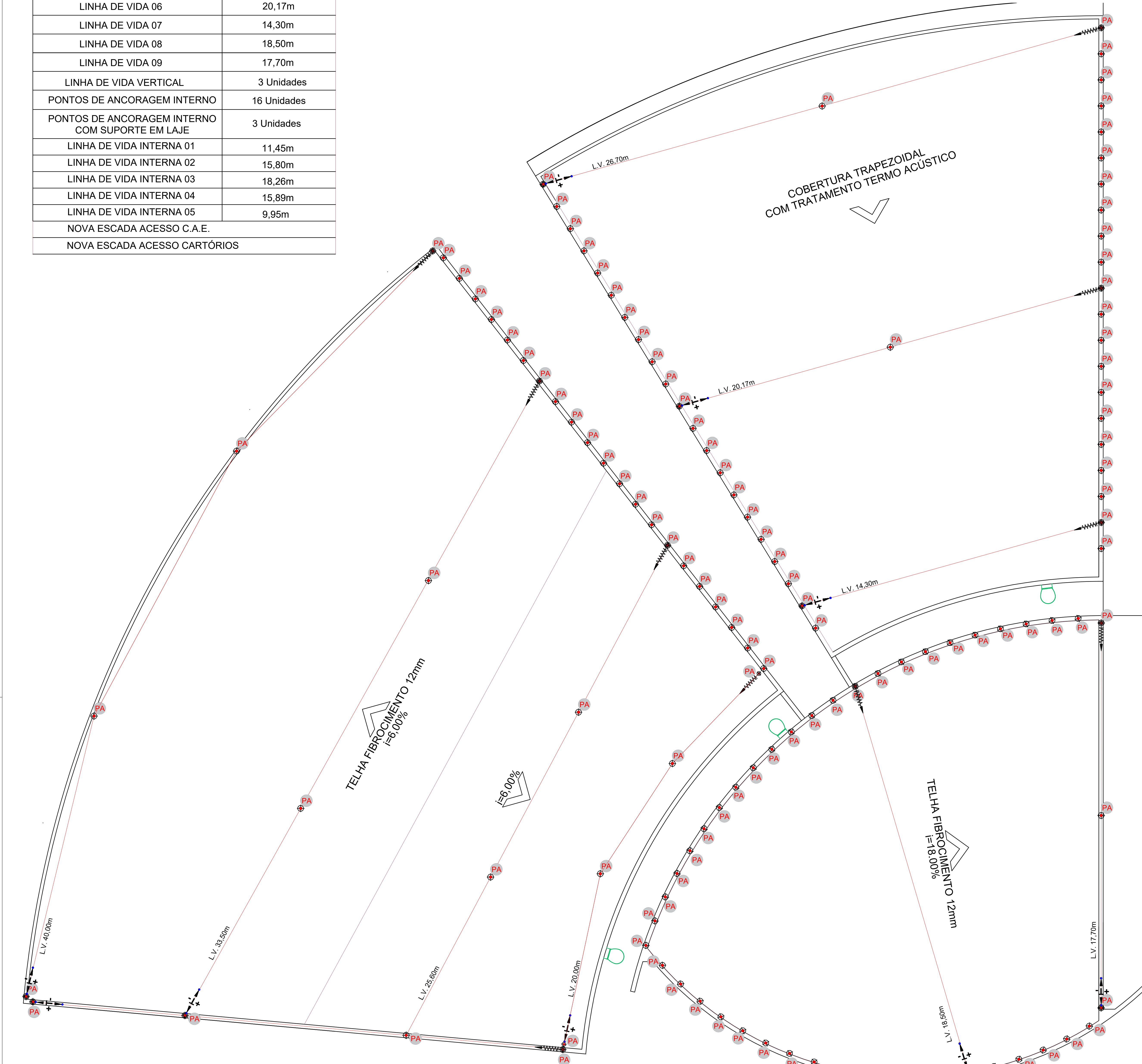
PROJETO DE ANCORAGEM COBERTURA ESCALA 1:75
